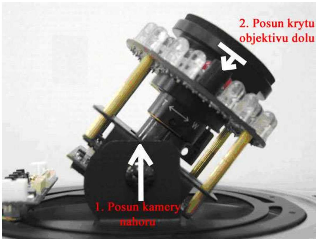
1. Nastavení výšky upevnění kamery pro dokonalé přilnutí světelného těsnění objektivu k dome krytu: Povolte 2 protilehlé šrouby v spodním držáku kamery a posuňte kameru nahoru ve směru šipky (1) a opět zafixujte šrouby. Po nasazení a dotažení DOME krytu musí být černý těsnící kroužek rovnoměrně a dokonale přitisknutý k vnitřní straně dome krytu.
