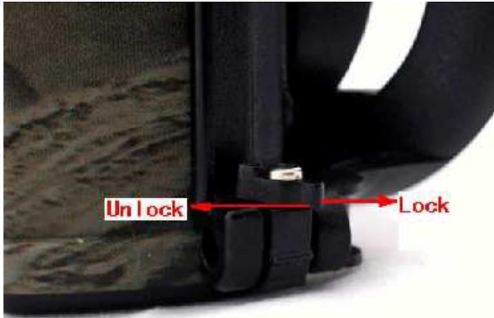
Odjištění pojistky pro vložení SIM, SD karty, baterií a přístup k USB portu
